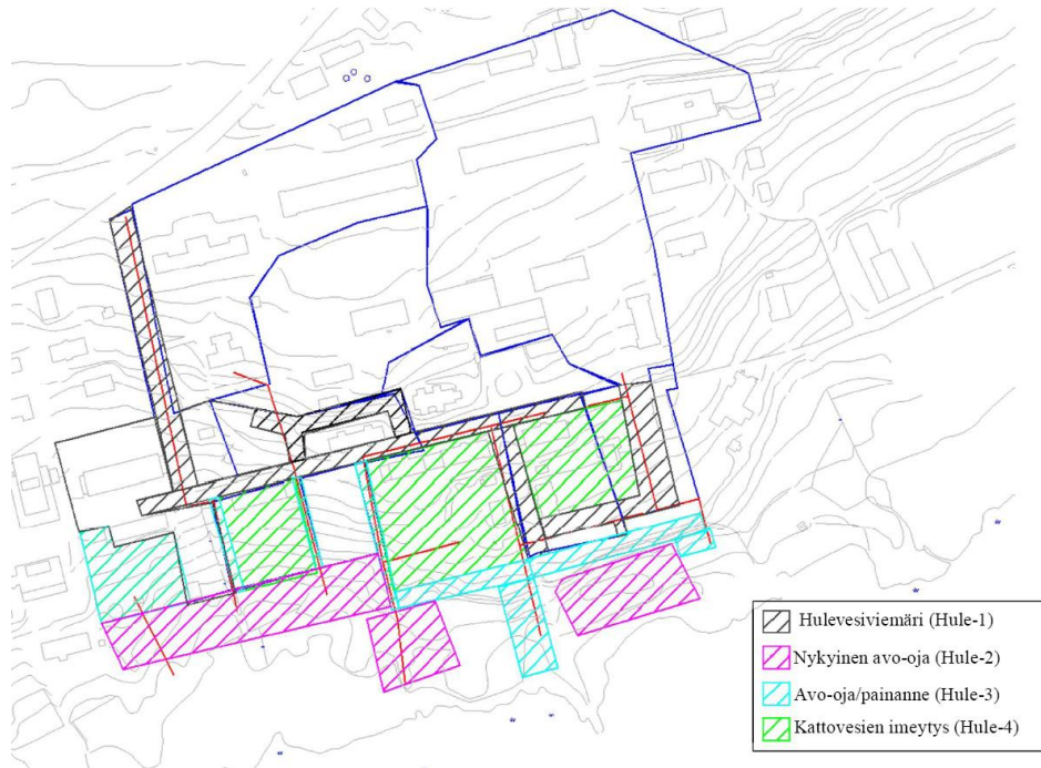
Kuva 11. Hulevesien hallintamenetelmät alueittain hulevesisuunnitelman mukaan, tummalla alustavat hulevesiverkoston ja avo-ojien linjaukset.
